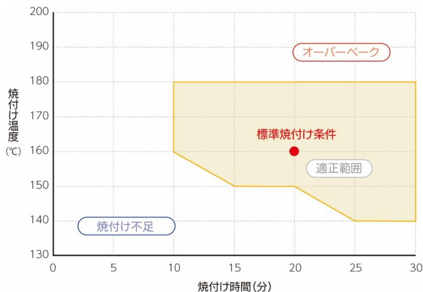
焼付け温度は被塗物の温度を示し、焼付け時間は温度キープ時間を示します。
