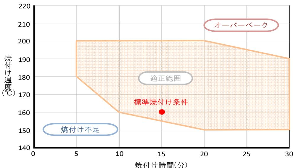
焼付け温度は被塗物の温度を示し、焼付け時間は温度キープ時間を示します。
